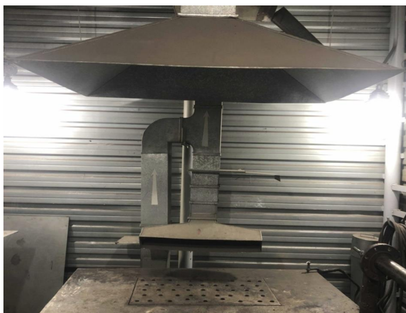
Рисунок 9 – Рабочее место электрогазосварщика на посту
