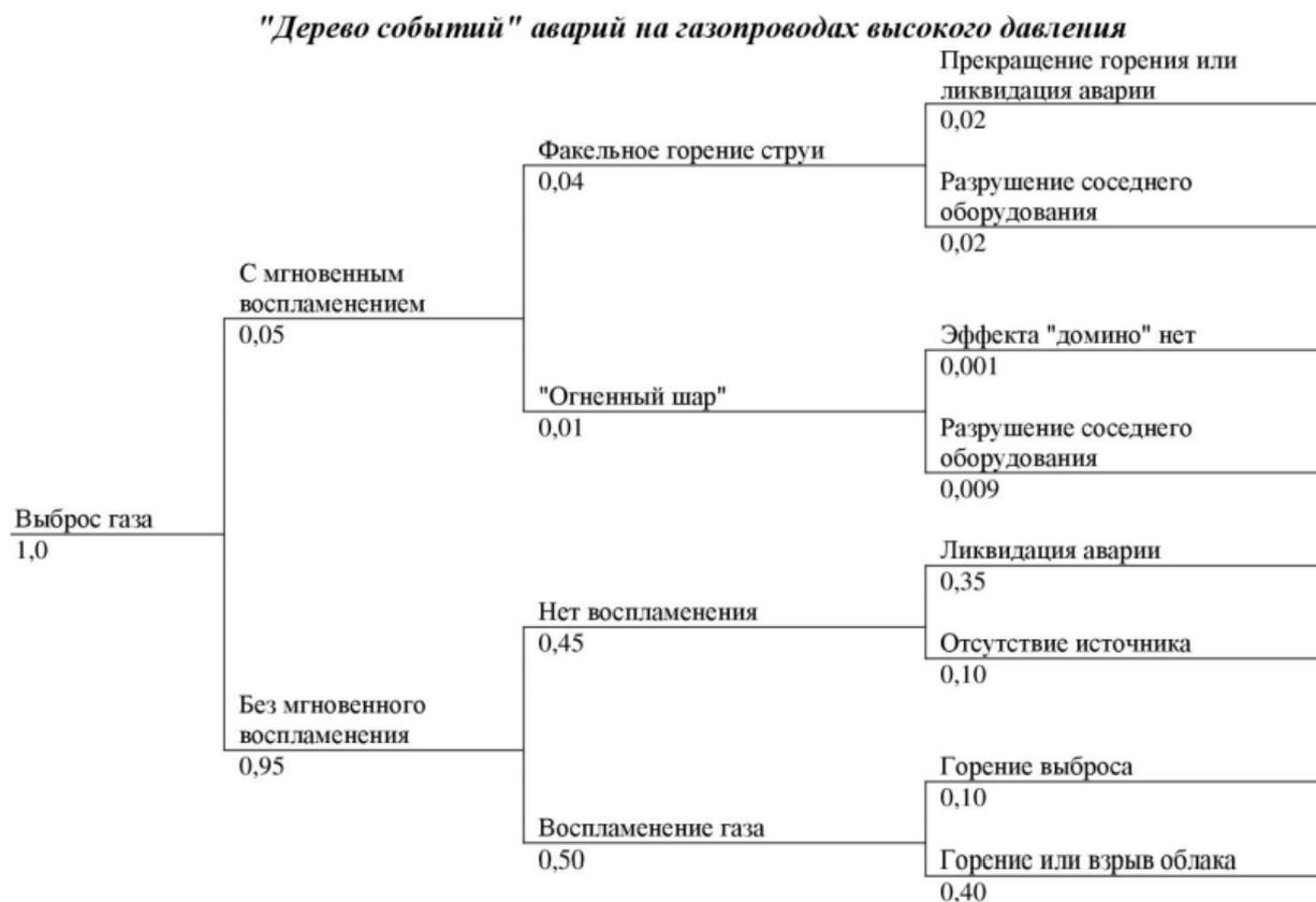
Рисунок Б.1 – Дерево событий аварий на газопроводе высокого давления
