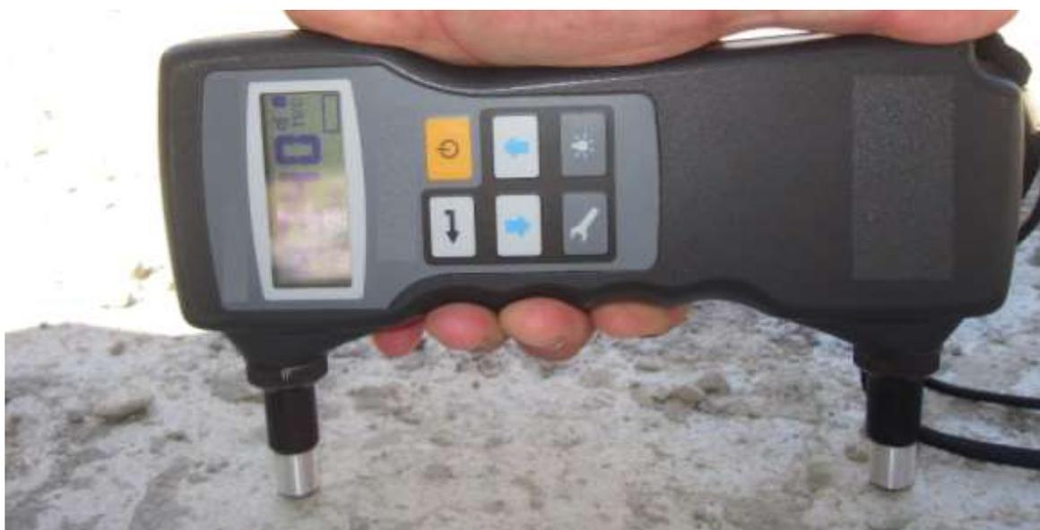
Рисунок 7 – Ультразвуковой контроль плиты перекрытия
