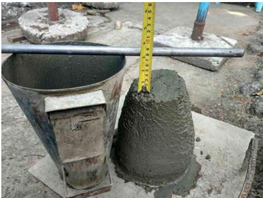
Рисунок 13 – Контроль подвижности бетонной смеси.
