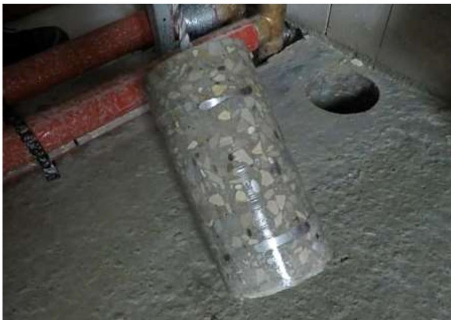
Рисунок 5 – Изъятие образца кернов из монолитного перекрытия
