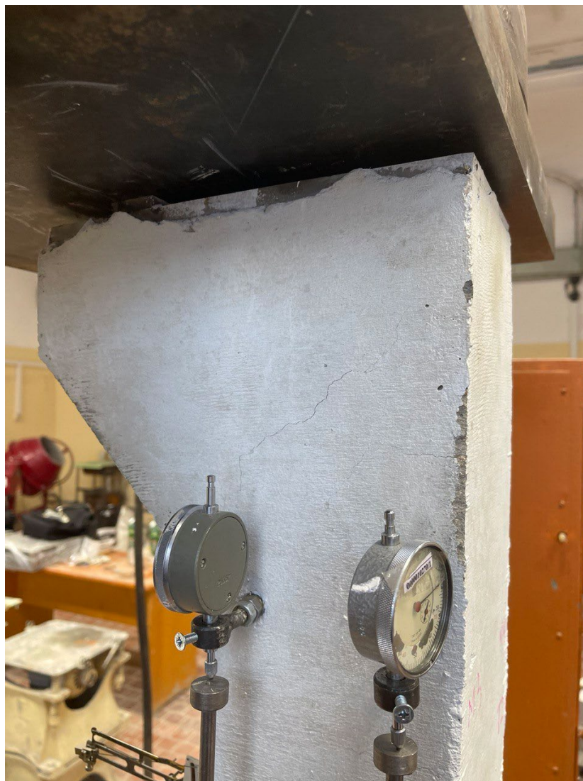
Рисунок 39 – Момент образования трещин в колонне КП150
