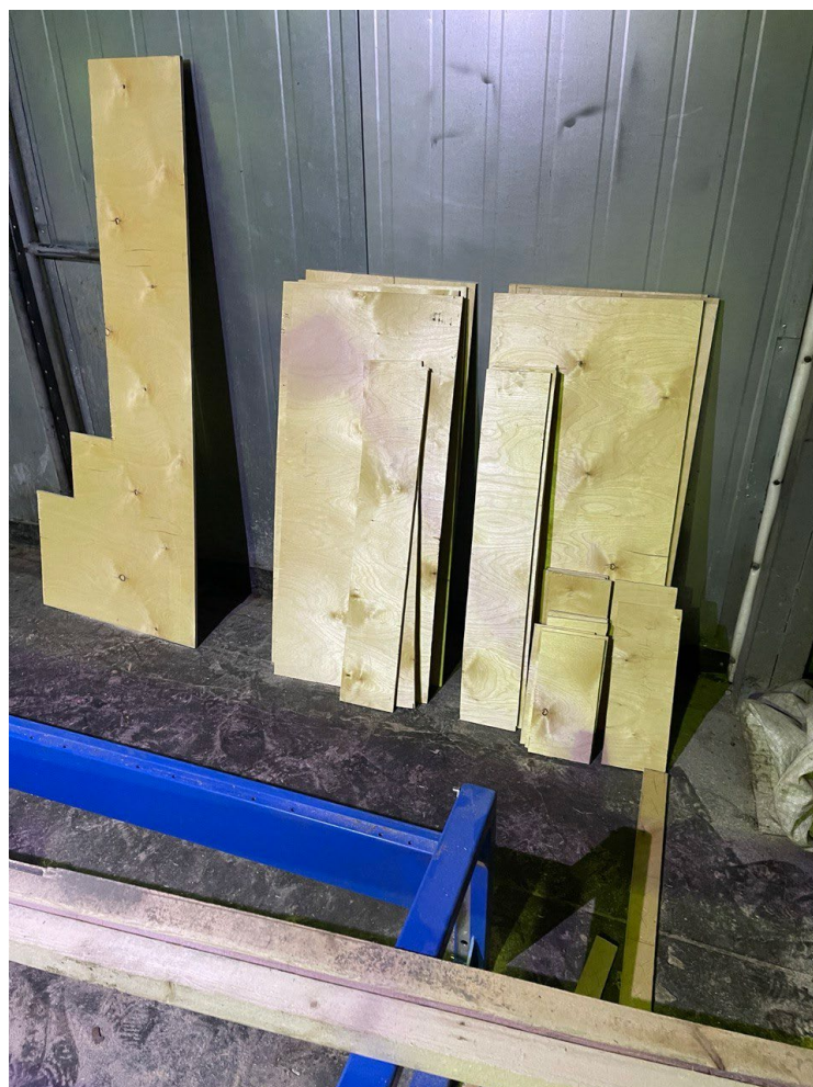
Рисунок 14 – Готовые детали опалубки
