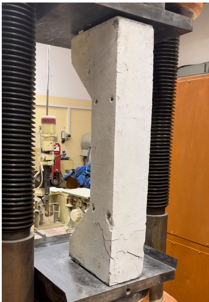
Рисунок 43 – Начало разрушения колонны КС150
