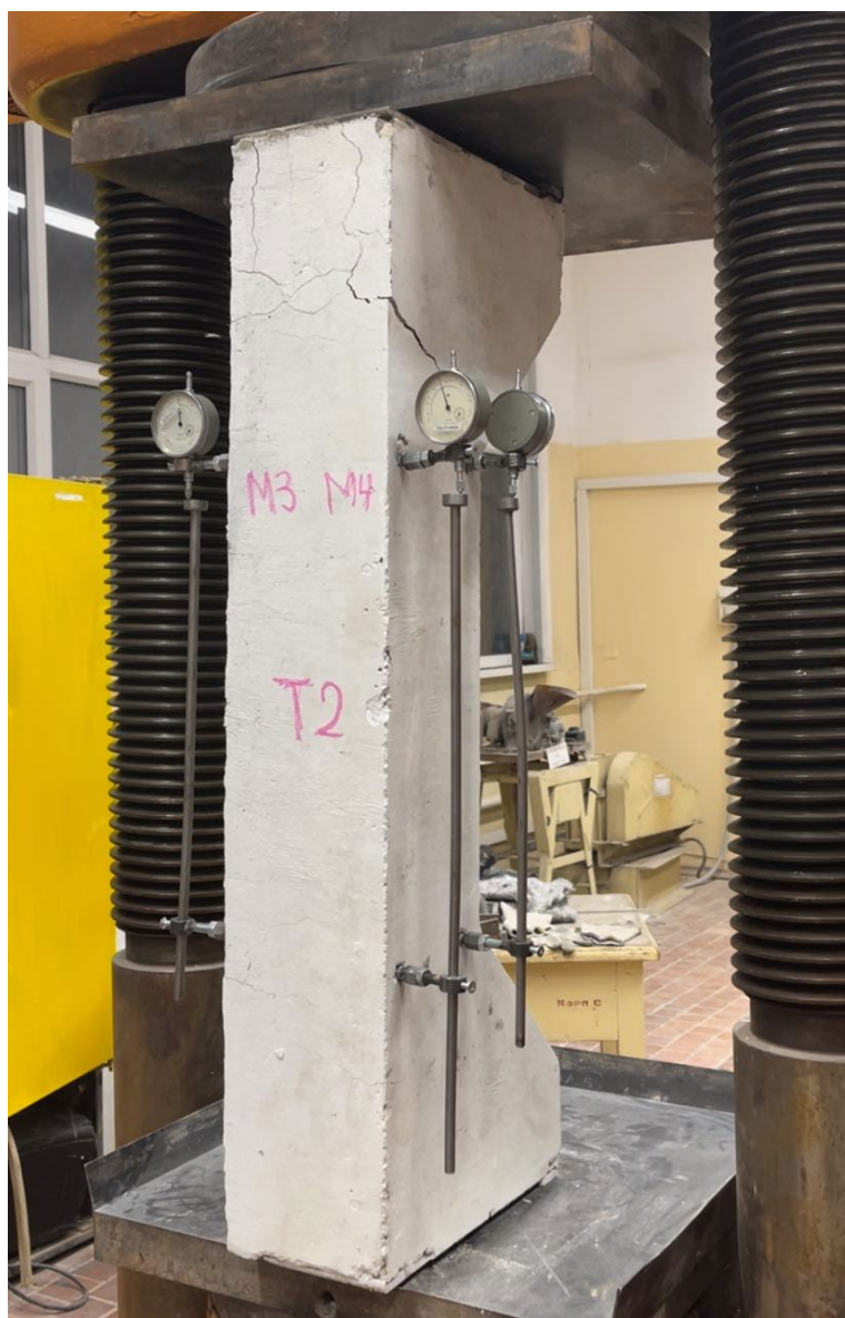
Рисунок 49 – Начало разрушения колонны КС212,5
