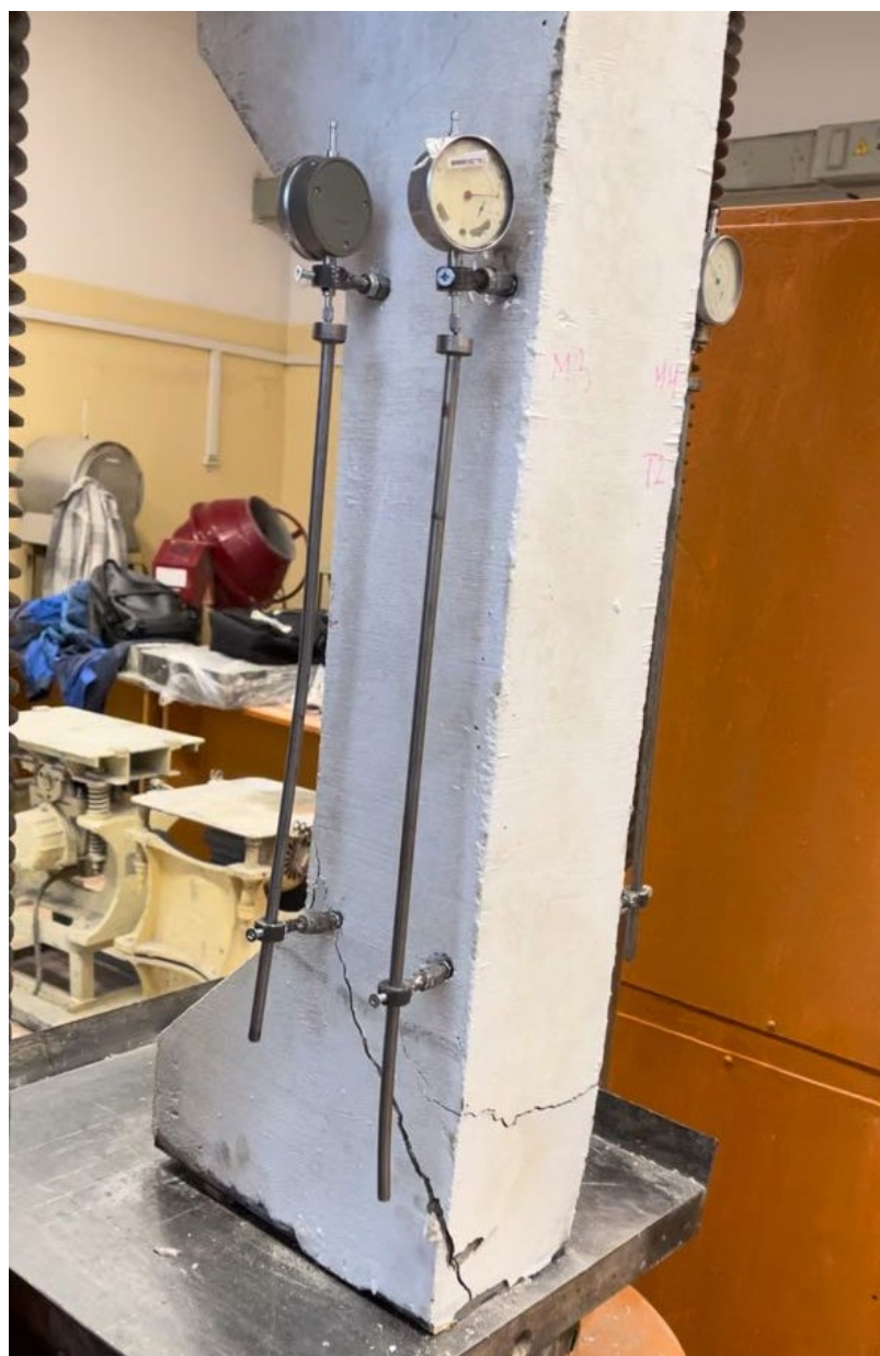
Рисунок 40 – Момент разрушения колонны КП150
