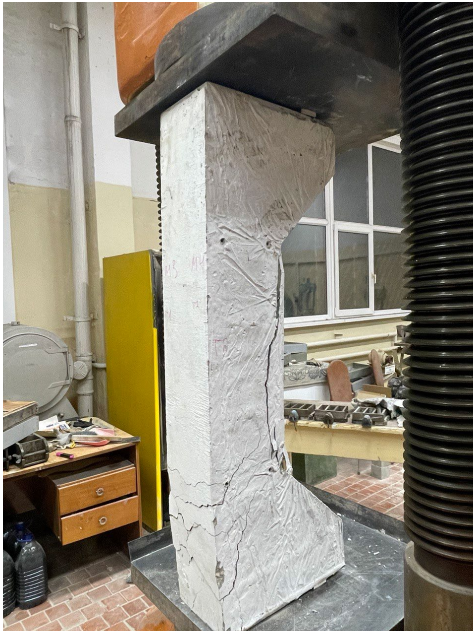
Рисунок 44 – Разрушенная колонна КС150
