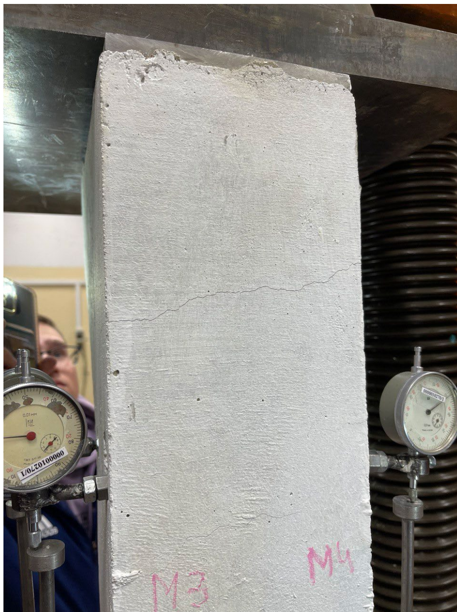
Рисунок 45 – Момент появления трещин в колонне КП212,5
