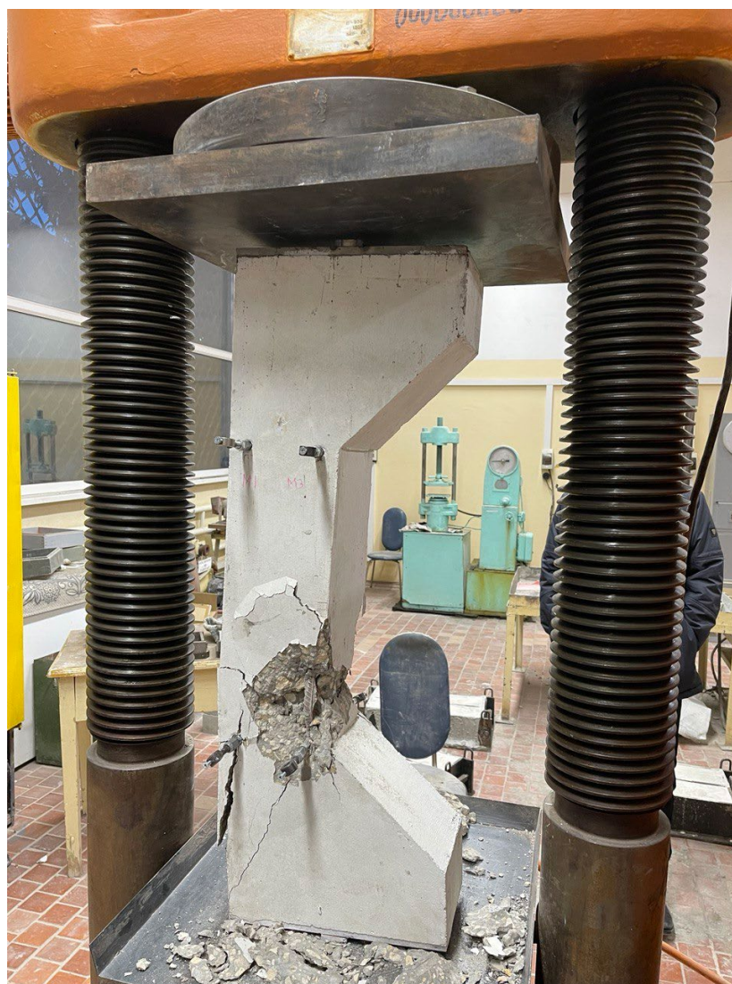
Рисунок 34 – Разрушенная колонна КС75
