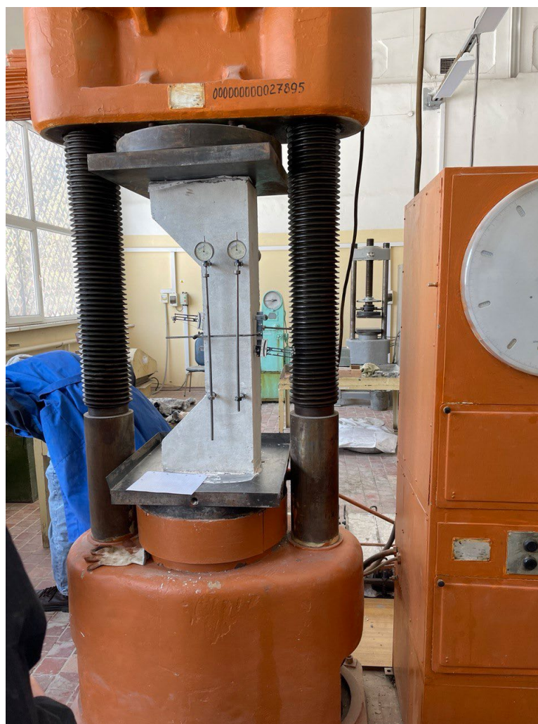
Рисунок 30 – Подготовка колонны к эксперименту
