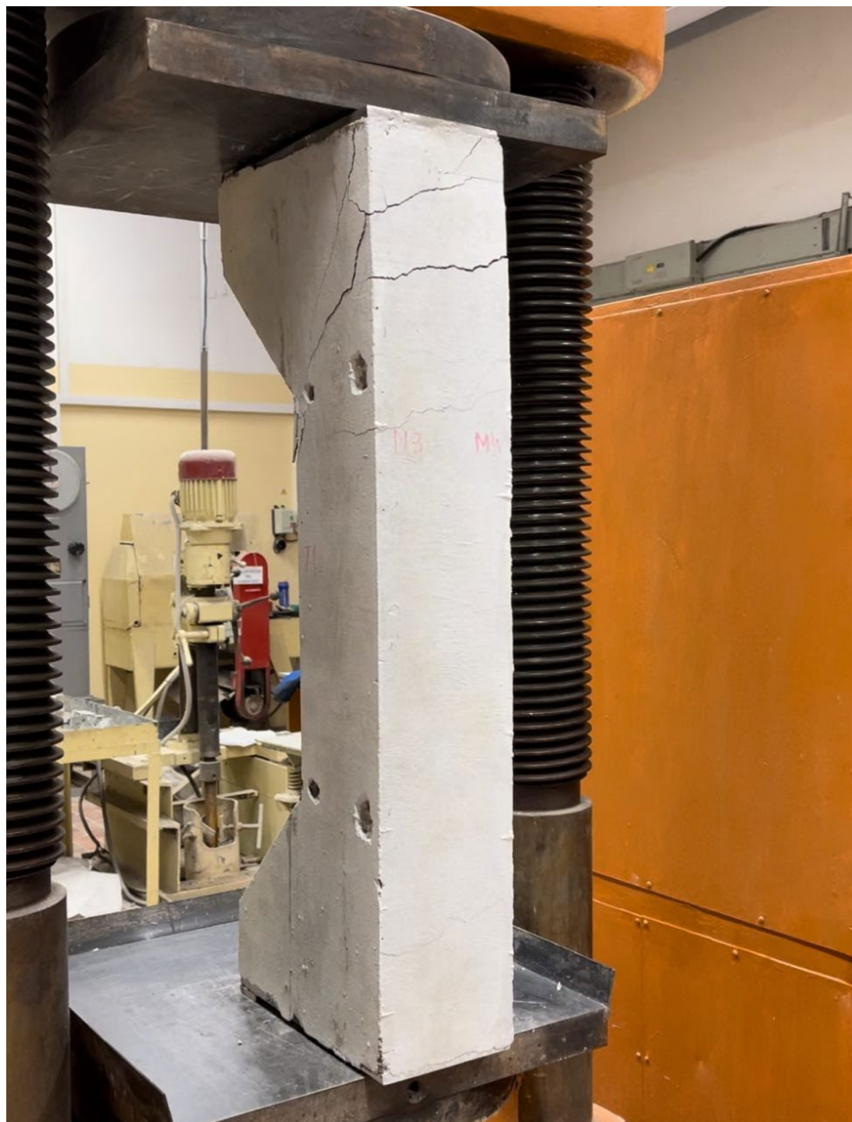
Рисунок 46 – Начало разрушения колонны КП212,5
