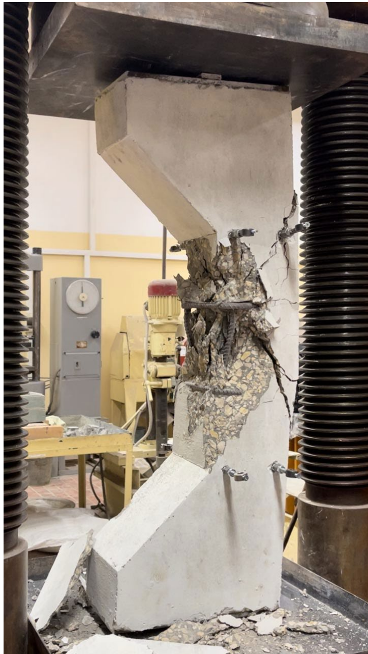
Рисунок 38 – Разрушенная колонна КП75
