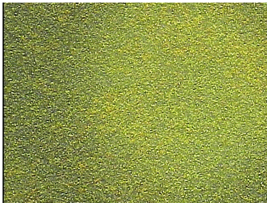
Рис. 2.1. Карбидная неоднородность (1 балл) стали S390PM, \times 100
