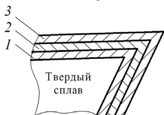
Рис. 8.9. Схема многослойного покрытия
