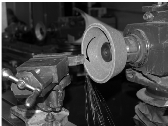
Рис. 7.22. Заточка токарного резца по главной задней поверхности на универсально-заточном станке в трехповоротных тисках
