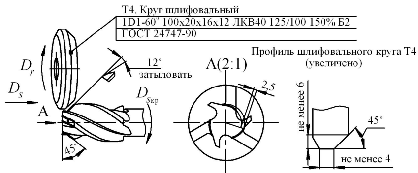
Рис. 9.7. Шлифование большого зуба на четвертом переходе
