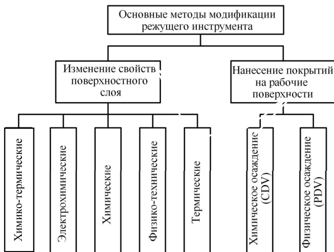
Рис. 8.1. Основные методы модификации рабочих поверхностей инструмента
