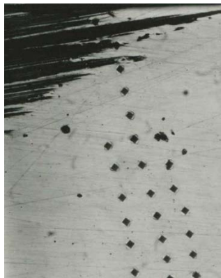
Рис. 6.9. Поверхность микрошлифа с отпечатками алмазной пирамидки через каждые 0,03 мм
