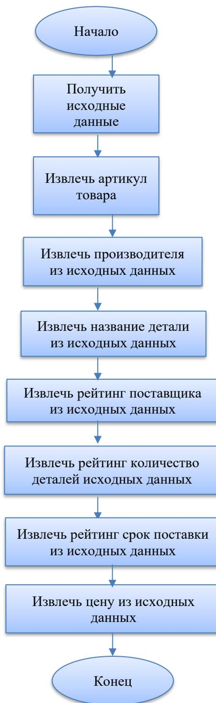
Рисунок 12 - Алгоритм извлечения данных с помощью АПД «SIMON»
