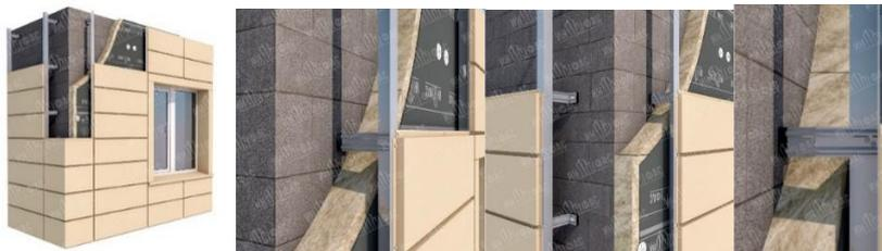
Рисунок 2 – Конструкция и крепление вентилируемого фасада из металлокасет
