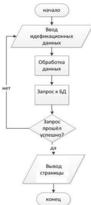
Рисунок 18 – Блок-схема модуля «Авторизация»
