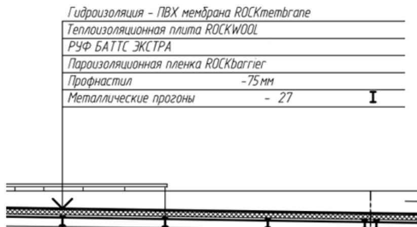
Рисунок 2 – Конструкция покрытия
