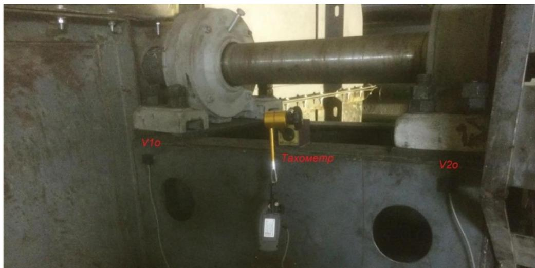
Рисунок 23 – Крепление датчиков к установке
