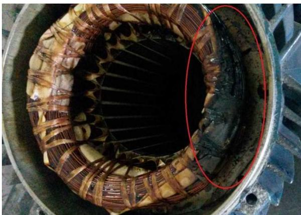
Рисунок 3 – Фотография разобранного электродвигателя, у которого была повреждена обмотка статора
