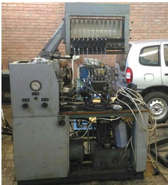
Рисунок 1 – Стенд проверки форсунок и ТНВД
