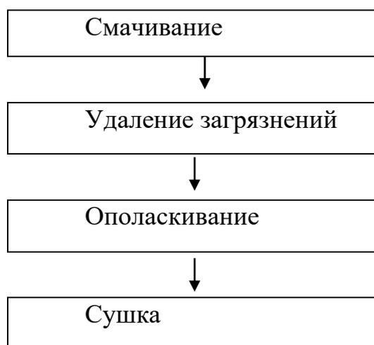
Рисунок 8 – Схема технологического процесса мойки
