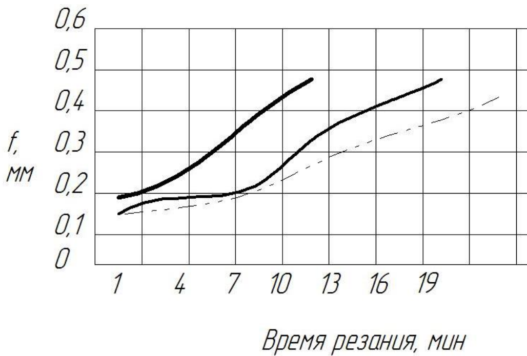
Рисунок 9 – Зависимость износа от времени резания при скорости резания 200 м/мин, подаче 0,11 мм/об и глубине резания 0,5 мм
