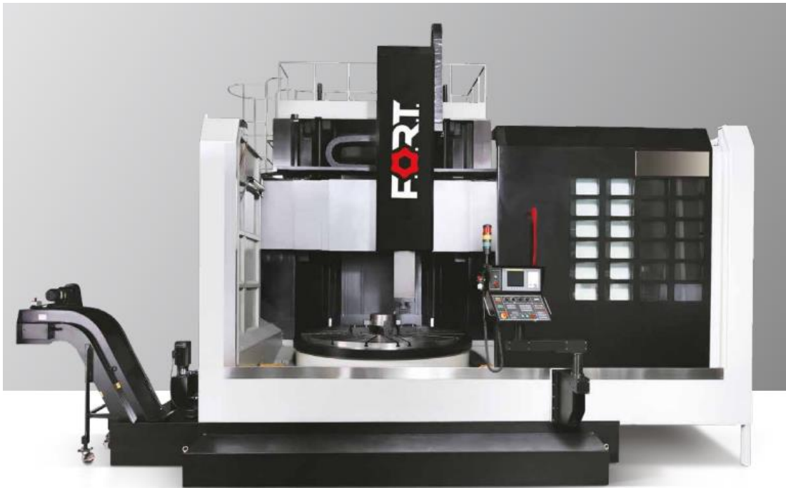
Рисунок 7 –Токарно-карусельный станок модель ВЛ-1200АТС+С
