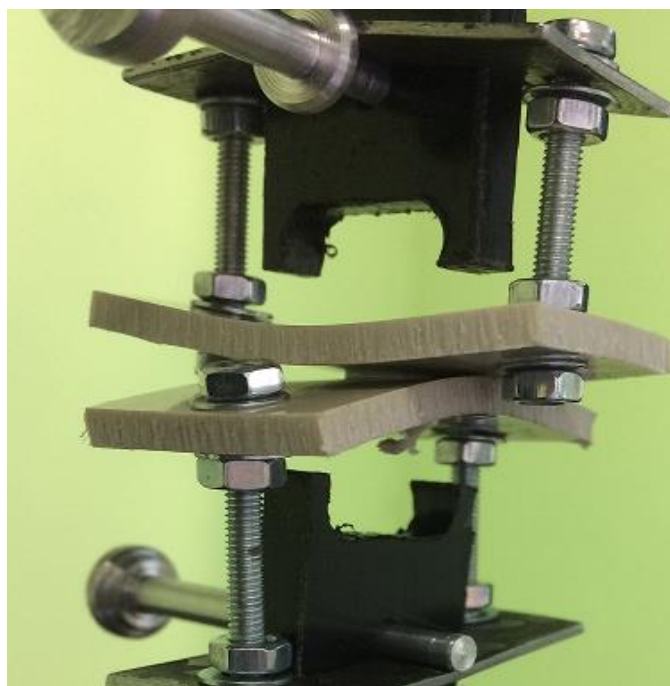
Рисунок 24 – Образец сварного соединения полипропилена во время испытания на растяжение
