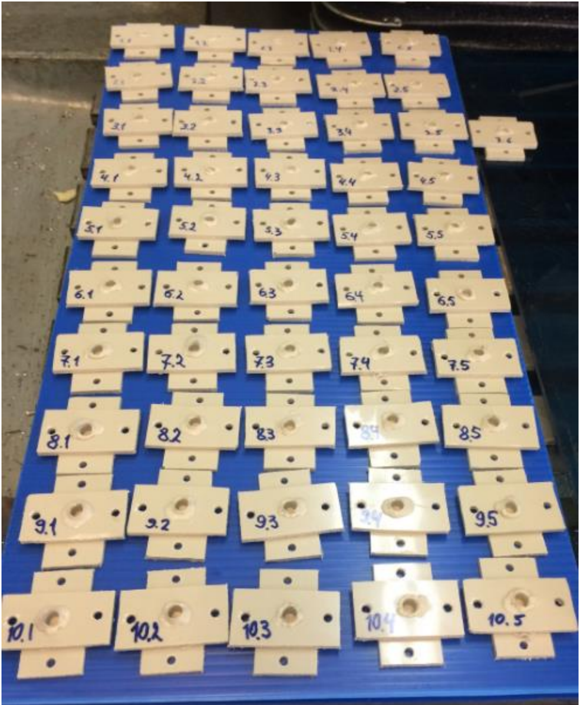
Рисунок 21 – Образцы сварных соединений после кондиционирования
