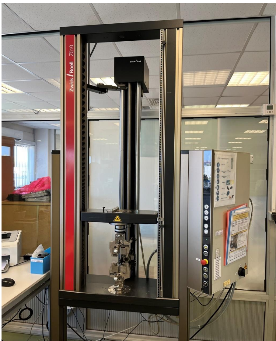
Рисунок 22 – Разрывная машина Zwick / Roell
