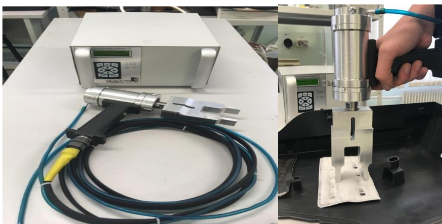
Рисунок 10 – Процесс УЗС при помощи сварочного пистолета
