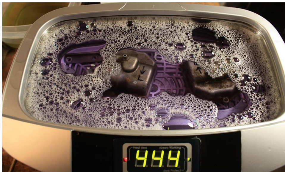
Рисунок 9 – процесс ультразвуковой очистки
