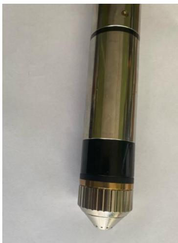
Рисунок 7 – Плазмотрон FY-A200H
