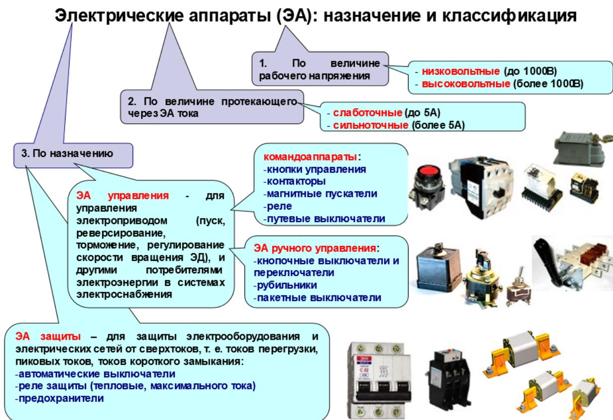
Рисунок 5 – Классификация и назначение электрических аппаратов
