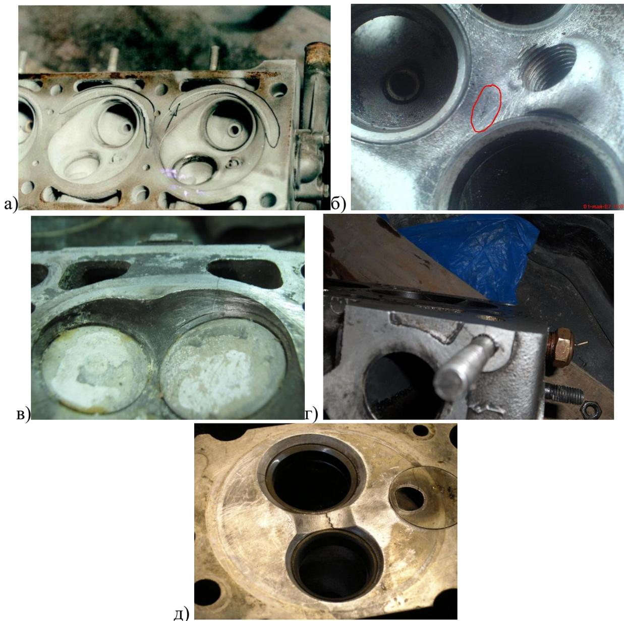
Рисунок 2 – Примеры дефектов головки цилиндра
