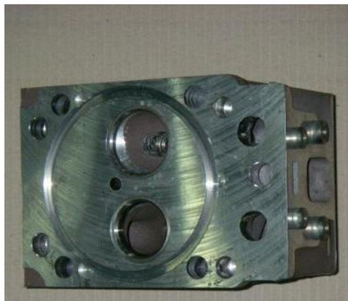
Рисунок 1 – Головка цилиндра КАМАЗ
