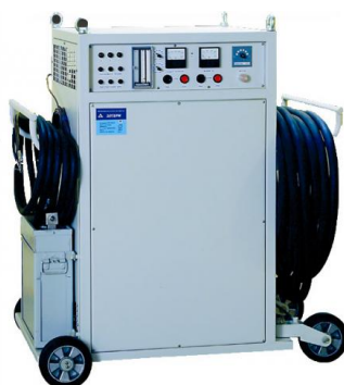
Рисунок 15 – Установка индукционного подогрева
