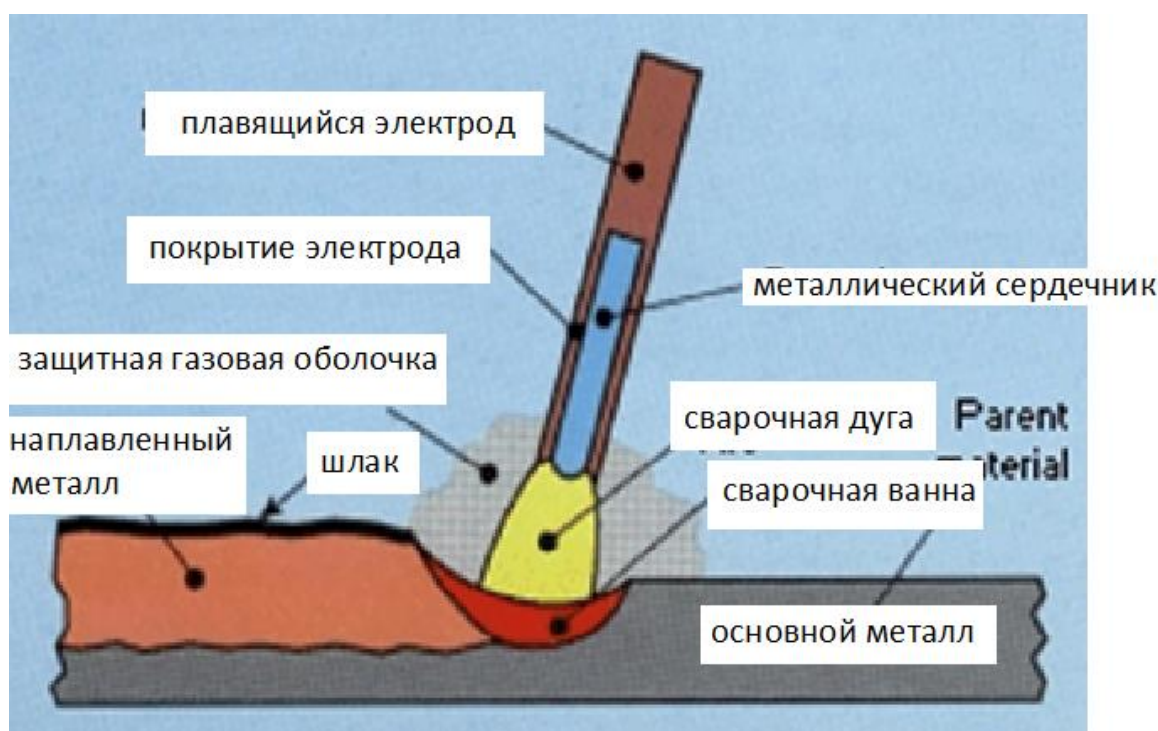
Рисунок 5 – Схема ручной дуговой сварки
