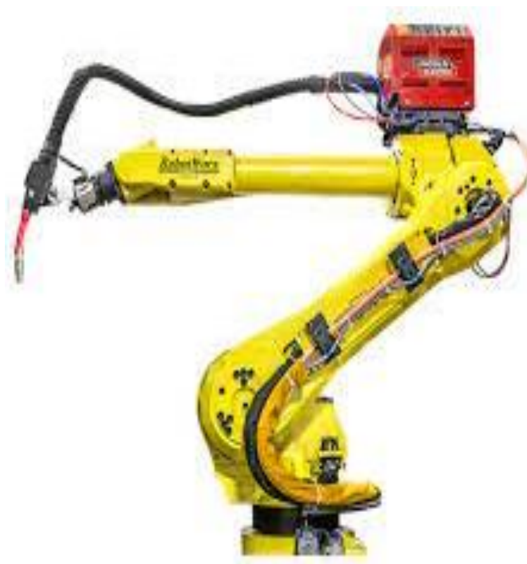
Рисунок 10 – Промышленный сварочный робот AM-120iB
