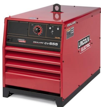
Рисунок 4 – Источник питания Idealarc DC-655
