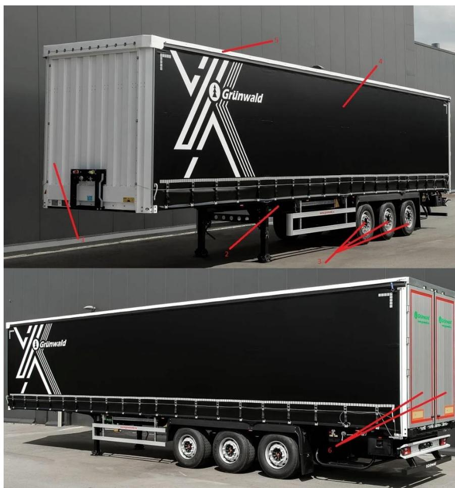
Рисунок 1 – Шторный полуприцеп Grunwald, где 1 - передняя стенка, 2 - рама полуприцепа, 3 - осевой агрегат, 4 – тент-штора, 5 – крыша, 6 – задние ворота
