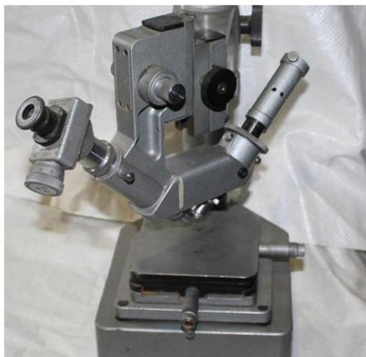
Рисунок 11 – Микроскоп МИС-11
