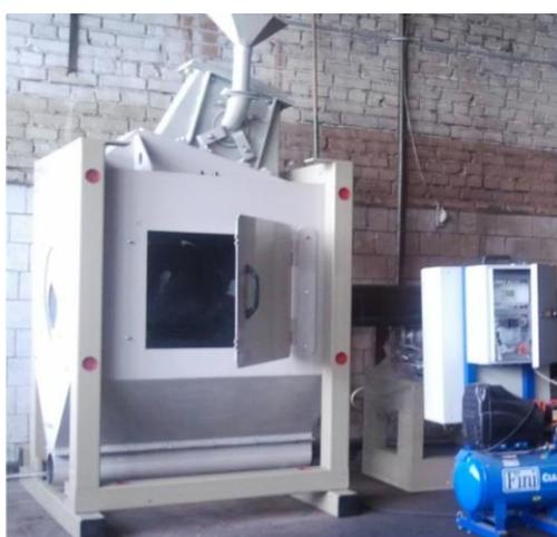
Рисунок 15 – Камера для дробеструйной обработки Avan-blast TL-H D3
