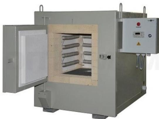
Рисунок 14 – Печь электрического нагрева СНО
