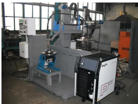
Рисунок 13 – Установка плазменной наплавки ОБ-2184
