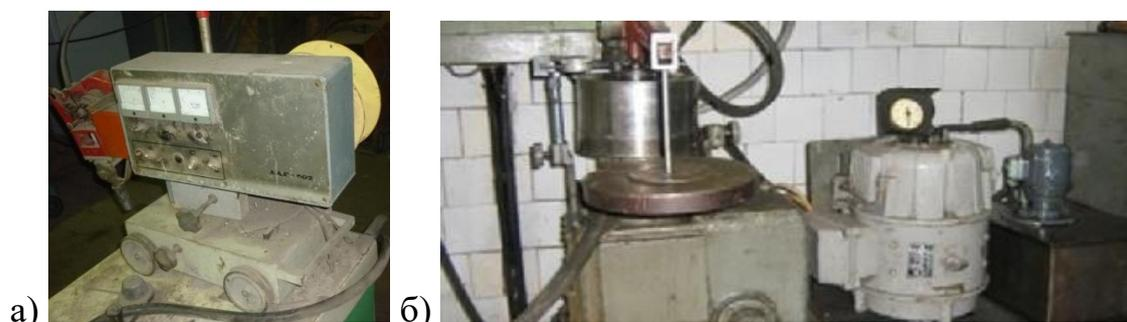
Рисунок 10 – Автомат для сварки и наплавки в среде защитных газов АДГ-502 (а) и стенд для испытания на истирание (б)
