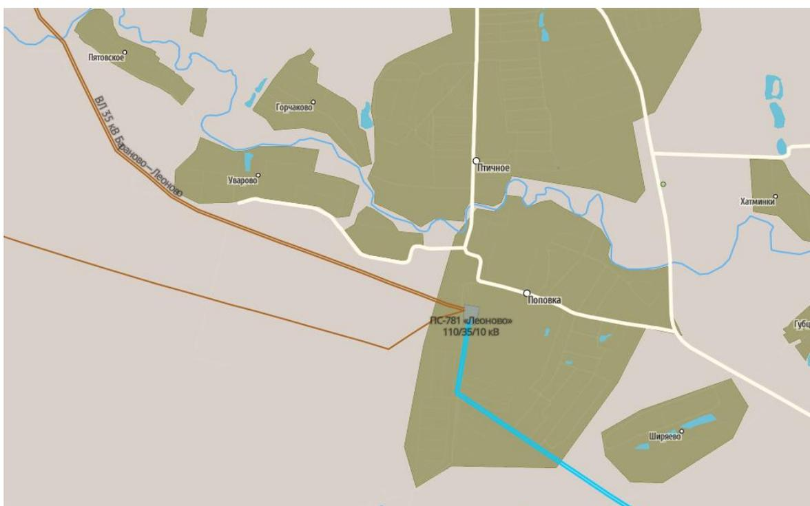
Рисунок 3 – План расположения питающих и распределительных сетей РТП-110/35/10 кВ «Леоново» на карте местности
