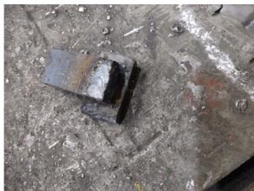
Рис. 2. Излом сварного соединения в околошовной зоне
