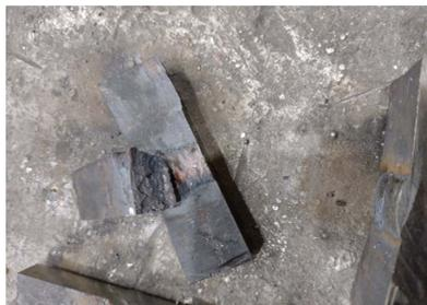
Рис. 3. Излом сварного соединения
