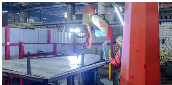
Рис. 1. Роботизированная сварка кровли
