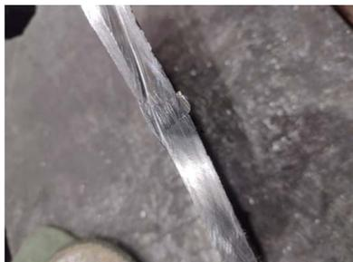
Рис. 1. Сварное соединение в разрезе
