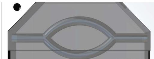
Рис. 2. Форма армирующих элементов станины
