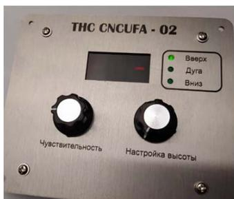
Рис. 2. Внешний вид блока управления длиной дуги
