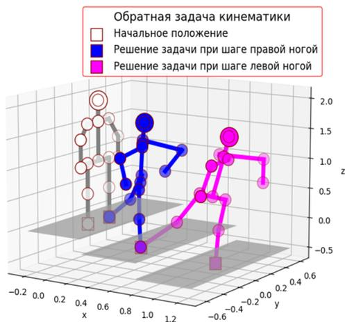
Рис. 2. Имитация движения робота по лестнице с помощью условной минимизации методом SLSQP библиотеки SciPy Python
