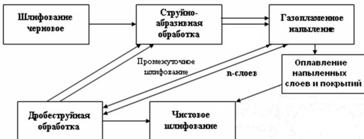
Рисунок 2.12 – Схема комплексного восстановления и упрочнения деталей с промежуточной и финишной обработкой
