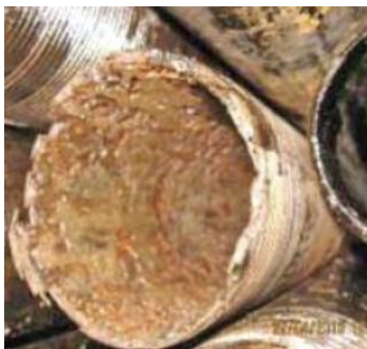
Рисунок 1.8 - Внешний вид НКТ (из обычной стали группы прочности «К») после отработки 350 суток
