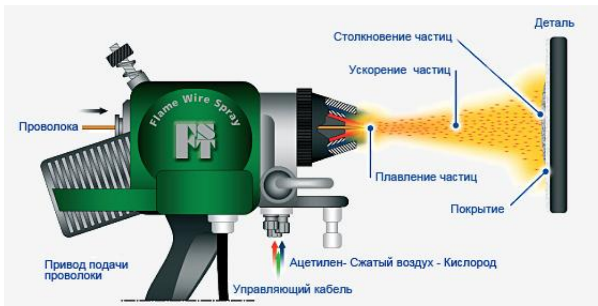
Рисунок 1.16 – Схема проволочного газопламенного напыления
