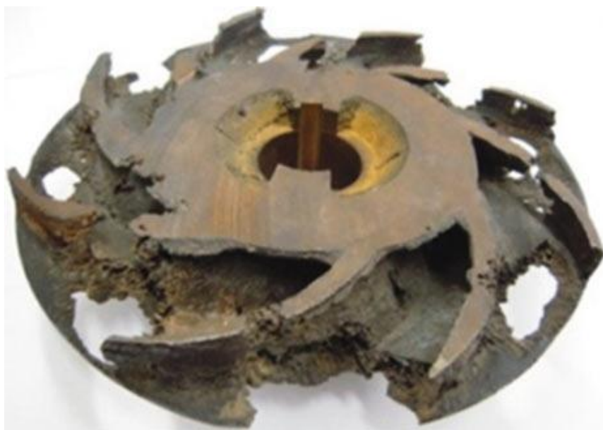
Рисунок 1.10 – Кавитационный износ рабочего колеса центробежного насоса магистрального трубопровода
