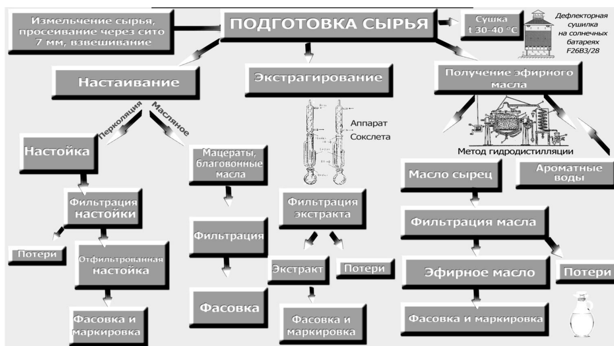
Рисунок 12 – Технологическая схема изготовления эфирных масел из сырья тимьяна и душицы
