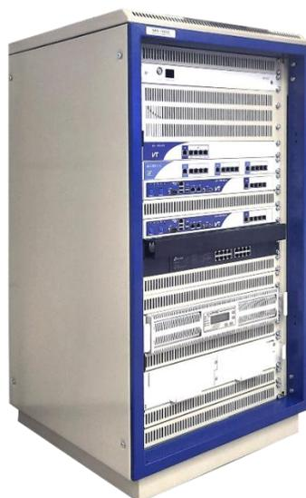
Рисунок 20 – Оборудование IP АТС МХ 1000
