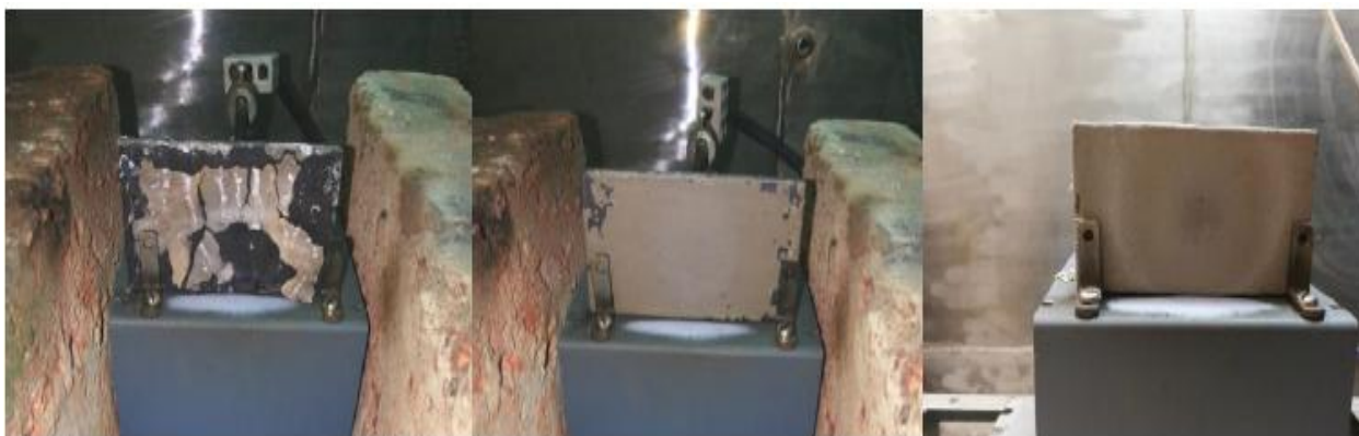
Рисунок 11 – Образцы металла, обработанные огнезащитным составом № 1 после огневого испытания: «образец после воздействия влажности; образец после воздействия теплосмен; образец без воздействий» [6]
