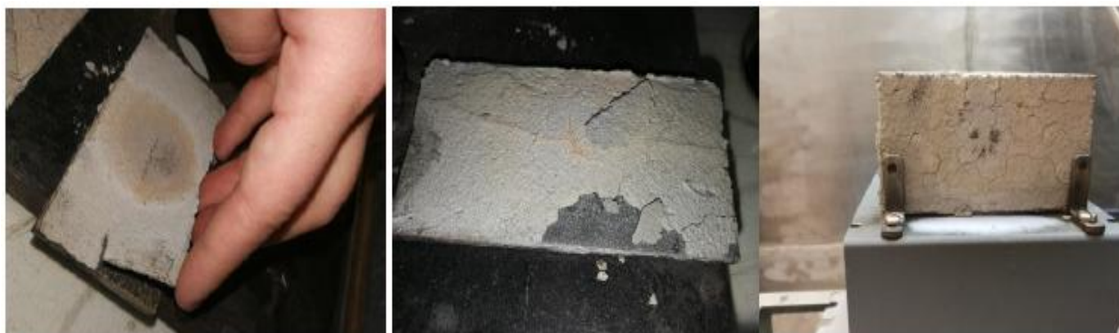
Рисунок 12 – Образцы металла, обработанные огнезащитным составом № 2 после огневого испытания: «образец после воздействия влажности; образец после воздействия теплосмен; образец без воздействий» [6]
