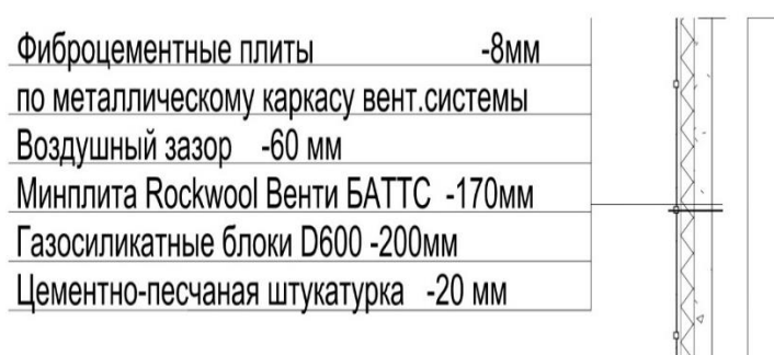
Рисунок 1 – «Конструкция наружной стены» [19]
