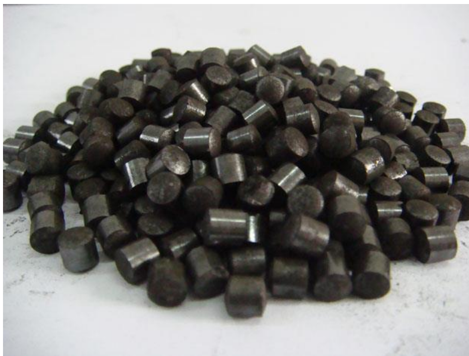
Рисунок 10 – Кальций-цинковый катализатор, изготавливаемый со смесью терморасширенного графита и шунгита
