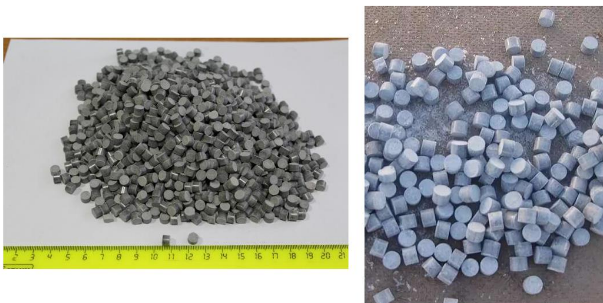
Рисунок 9 – Кальций цинковый и цинк хромовый катализатор
