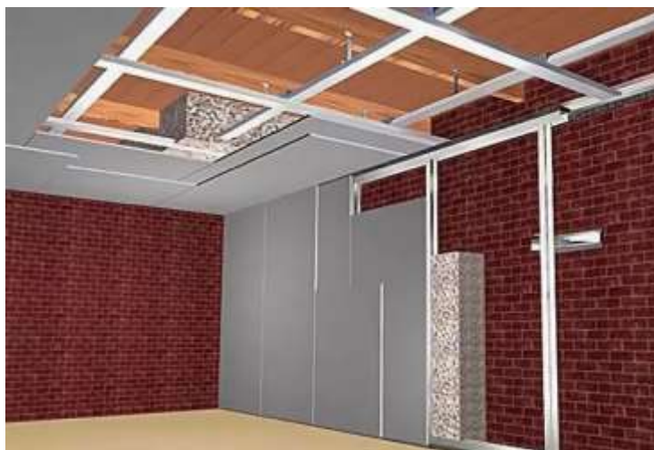
Рисунок 9 – Установка звукопоглощающих облицовок
