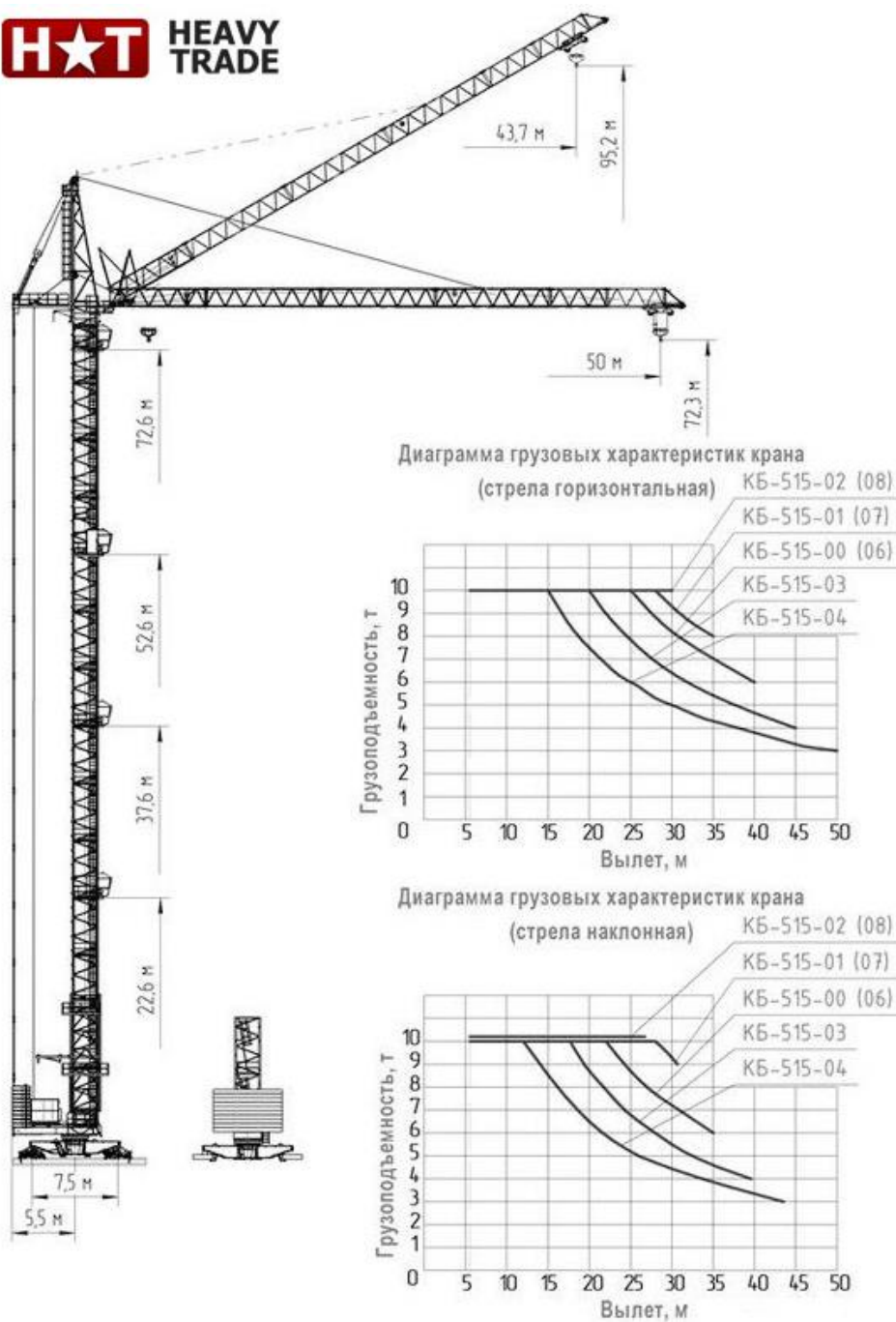
Рисунок 7 – Грузовые характеристики крана КБ-515
