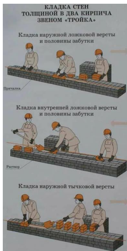
Рисунок 6 – Схема рабочего места каменщиков.
