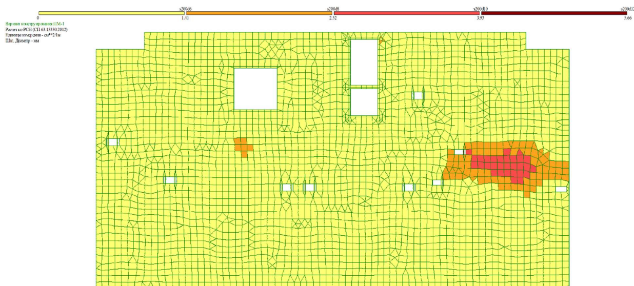
Рисунок 8 – Нижнее армирование перекрытия этажа по оси Y
