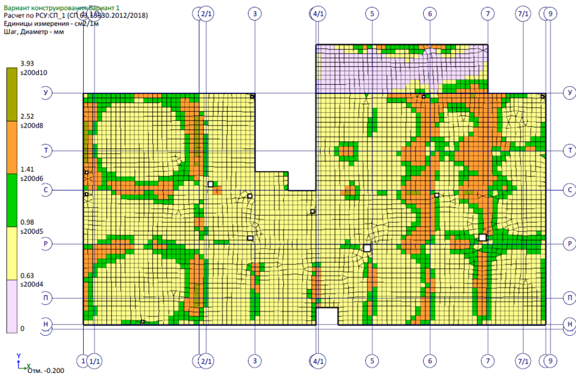
Рисунок 5 – Площадь полной арматуры на 1пм по оси X у верхней грани плиты
