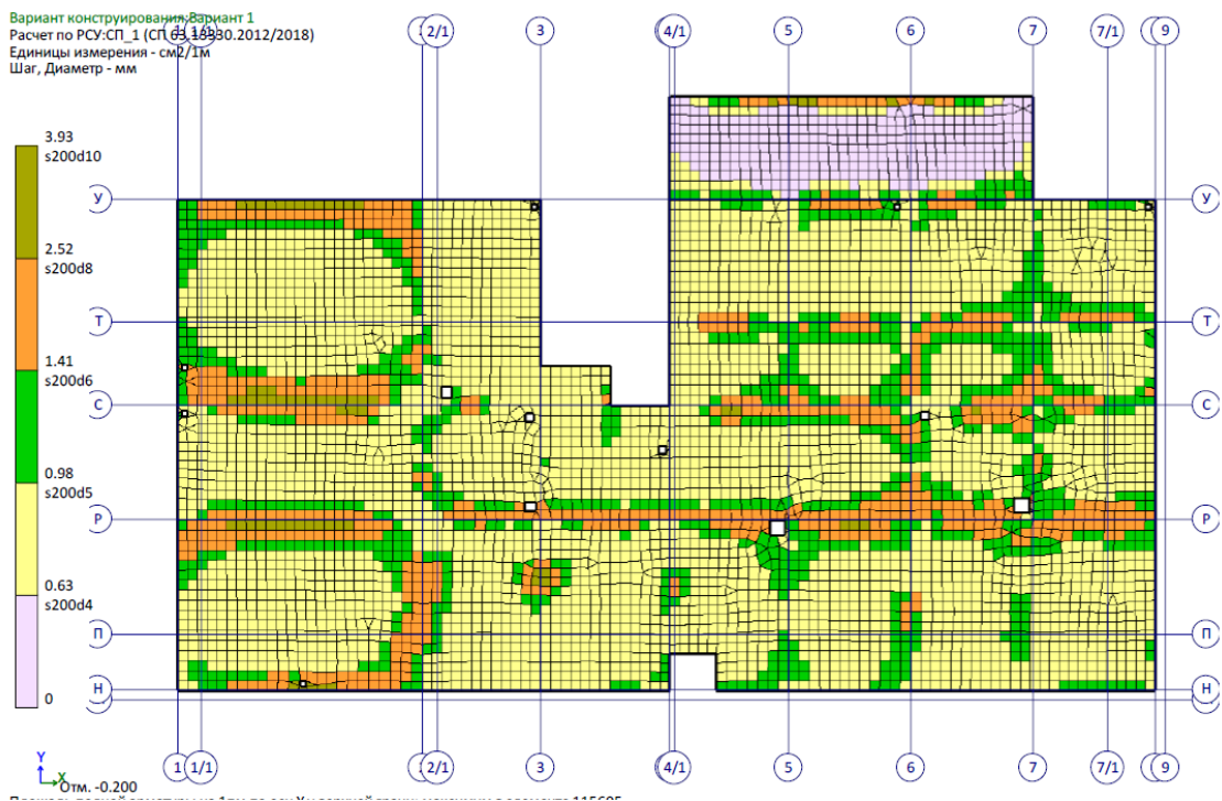
Рисунок 7 – Площадь полной арматуры на 1м по оси Y у верхней грани плиты
