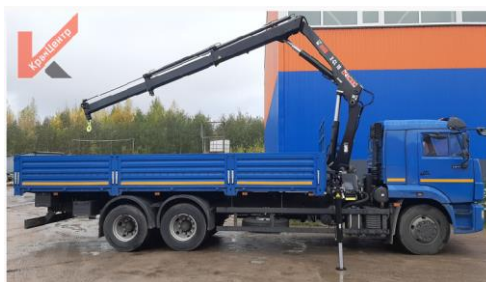
Рисунок 28 - Бортовой автомобиль КАМАЗ-65117 (6×4) с краном-манипулятором Hiab X-CL 16 B-2
