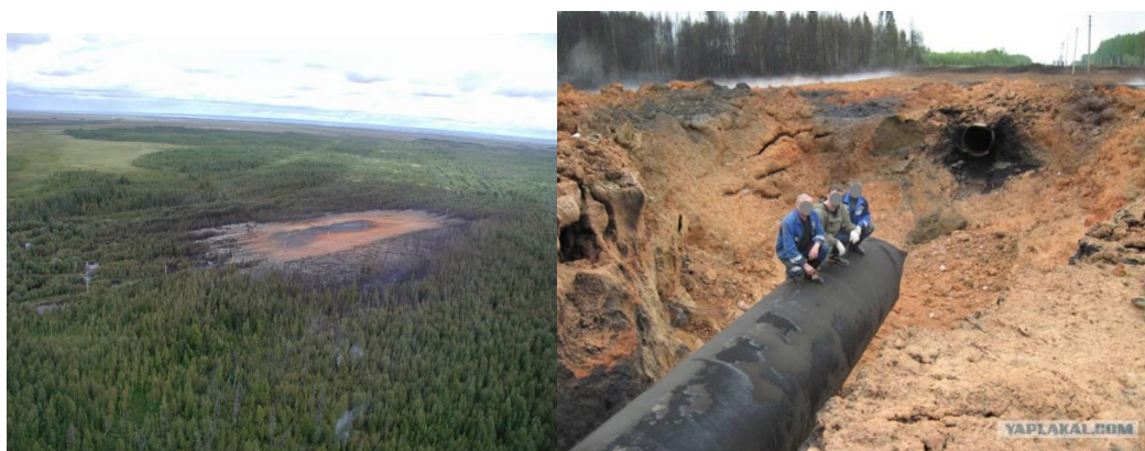
Рисунок 3 - Последствия после взрыва МГП
