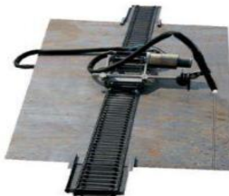
Рисунок 25 - специальная цепь для перемещения трубореза.
