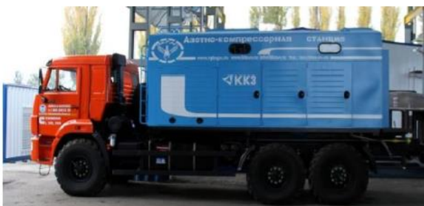
Рисунок 32 - Передвижная азотная компрессорная установка ТГА-10/251 С-95
