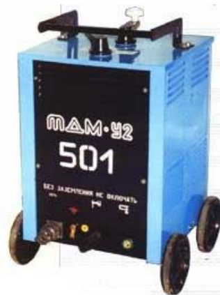
Рисунок 12 – Применяемые при выполнении базовой технологии источники питания: сварочный выпрямитель ВДУ-506 (а) и сварочный трансформатор ТДМ-501 (б)
