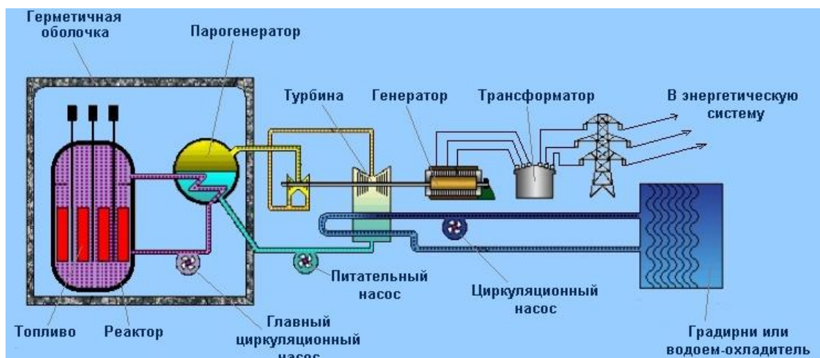
Рисунок 1 – Принципиальная схема устройства атомной электрической станции
