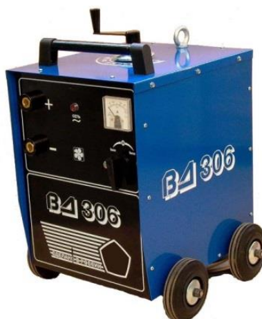
Рисунок 14 – Сварочный выпрямитель ВД-306
