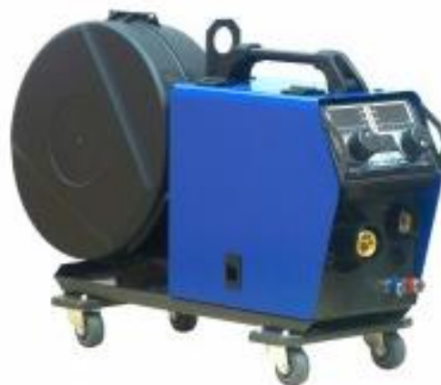
Рисунок 20 – Применяемое для сварки оборудование: источник питания Invertec STT (а) и механизм подачи LF-33 (б)
