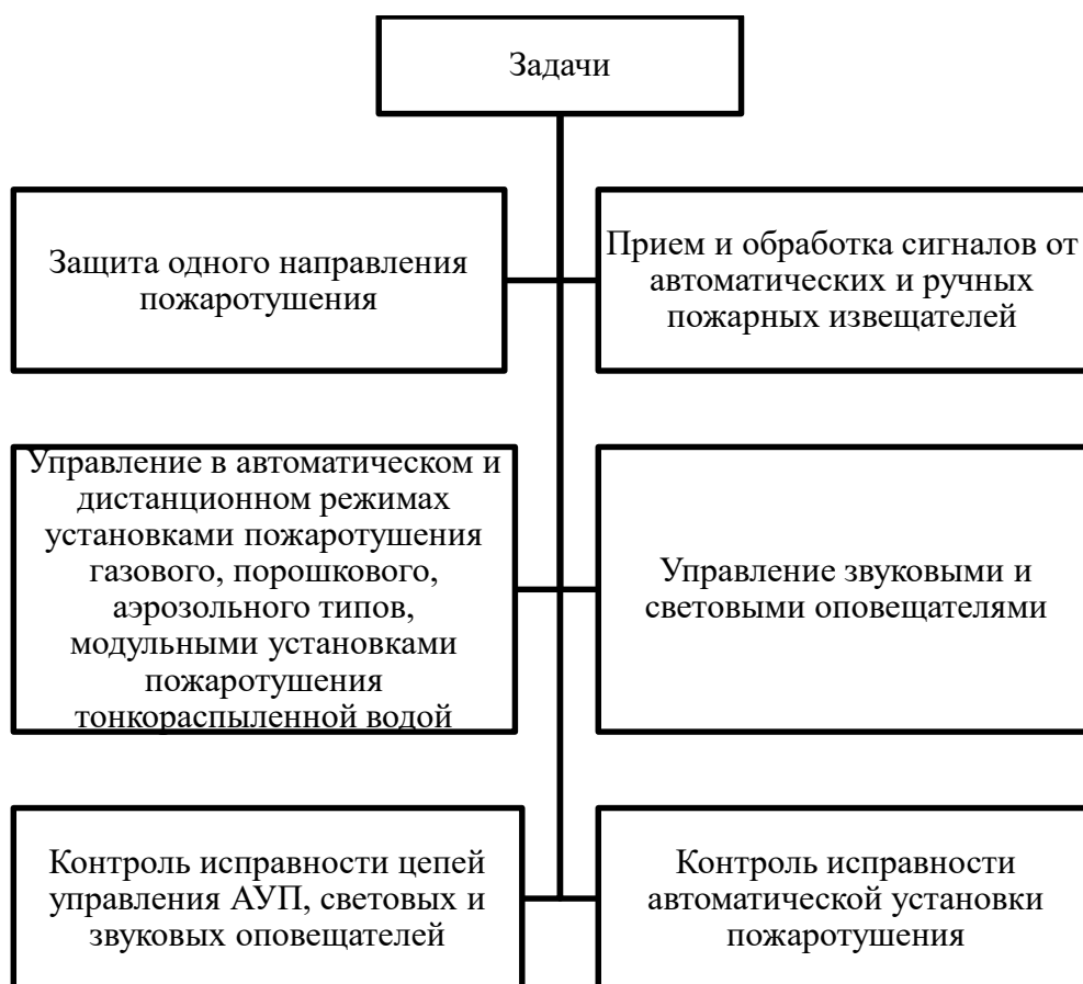
Рисунок 8 – Задачи блока приёмно-контрольного и управления «С2000-АСПТ»
