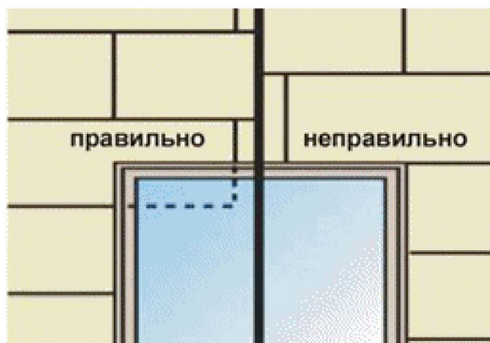
Рисунок 3.2 - Приклеивание плиты в углах проемов
