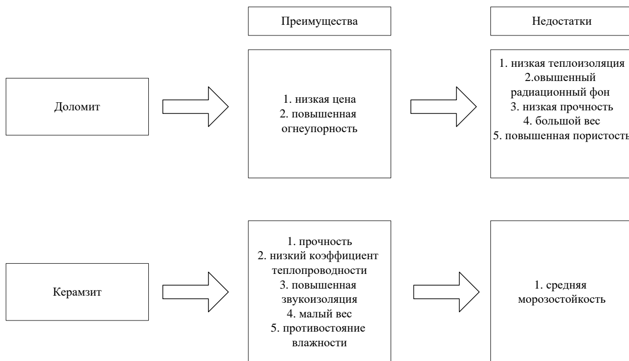
Рисунок 21- Сравнительные характеристики строительных блоков из доломита и керамзита
