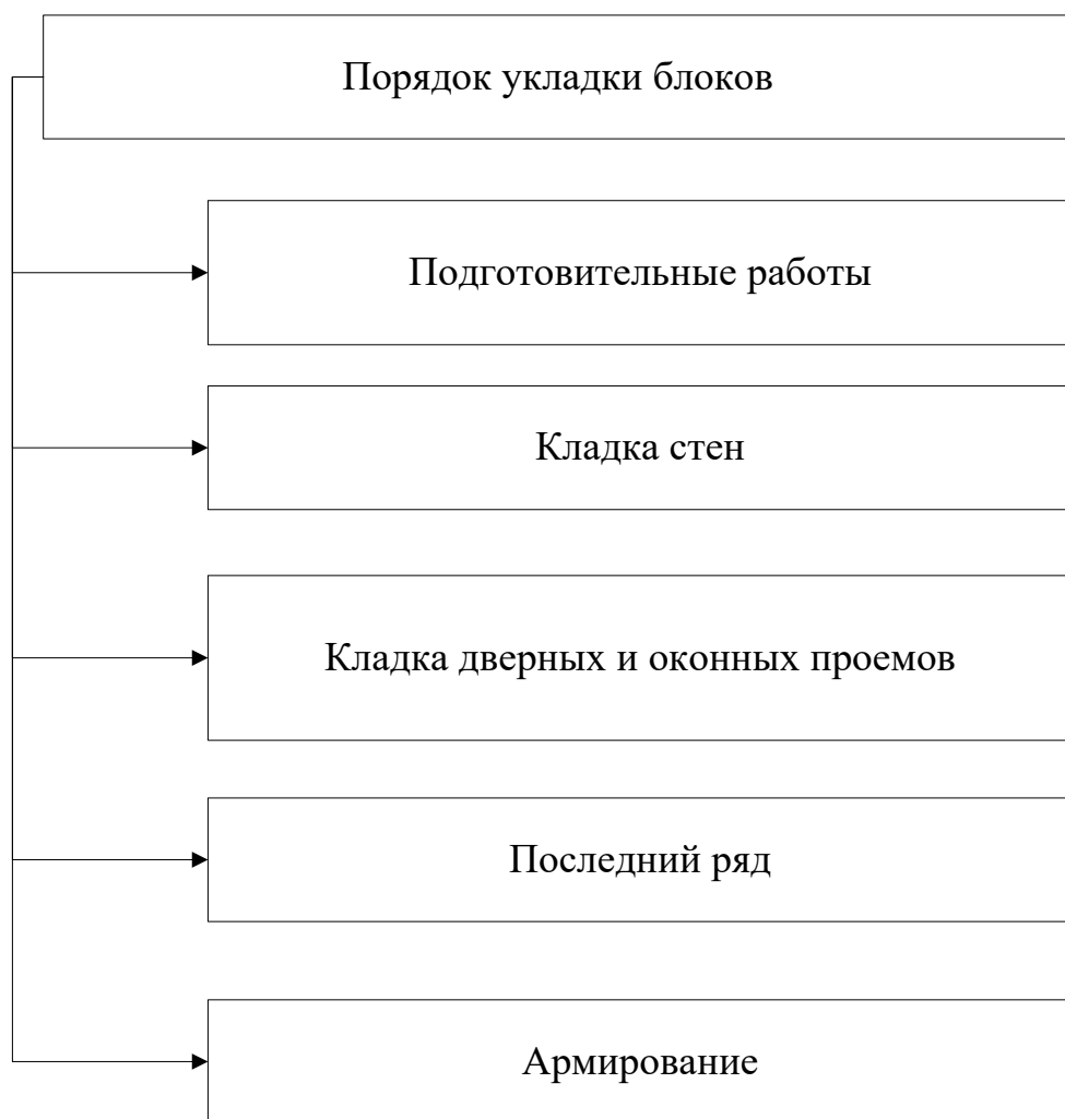
Рисунок 18 – Порядок укладки блоков
