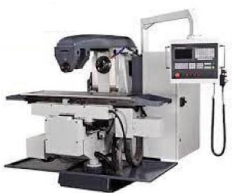
Рисунок 6 – Горизонтально-фрезерный станок с ЧПУ ХК6032
