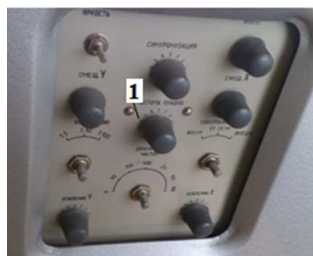
Рис. 3.3. Изображение боковой панели осциллографа: 1 – регулировочный винт «частота плавно»
