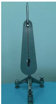
Рис. 2.1. Схема установки и ее изображение: O, O' – точки подвеса; L – приведенная длина физического маятника
