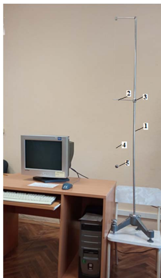
Рис. 10.1. Экспериментальная установка: 1 – вертикальная стойка; 2 – горизонтальная планка; 3 – стопорный винт; 4 – нить; 5 – шарик
