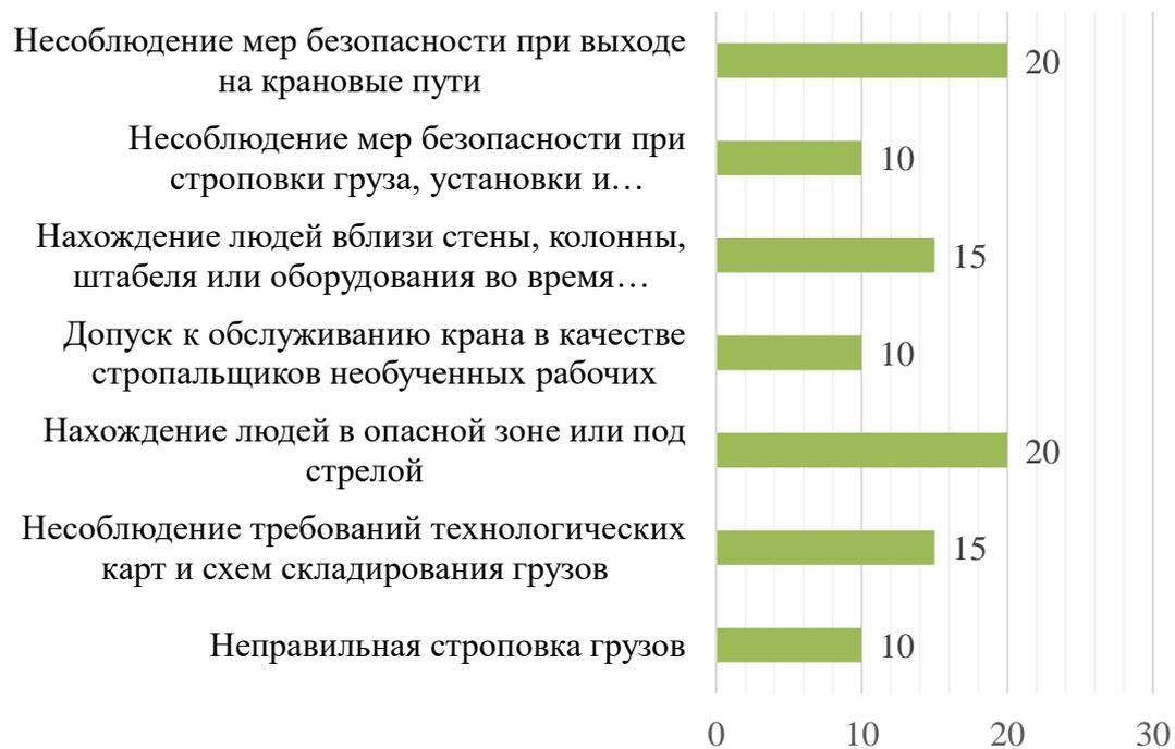
Рисунок 7– Причины травматизма в результате инцидентов при работе грузоподъемных кранов, %
