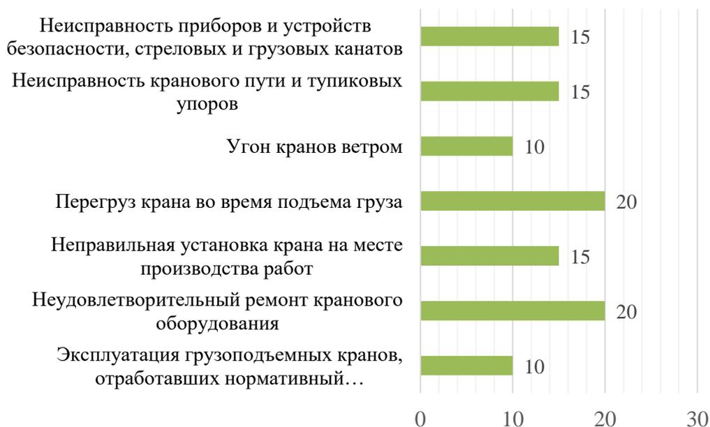
Рисунок 6 – Причины аварий при работе грузоподъемных кранов, %
