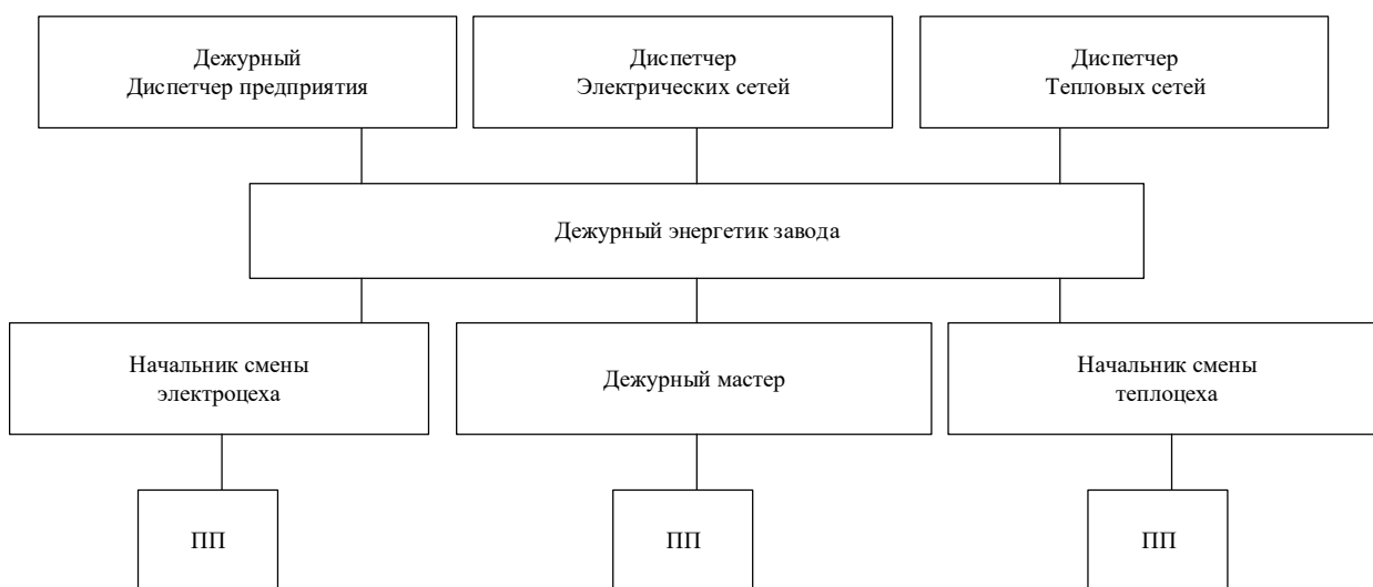
Рисунок 2 – Схема оперативного дежурного управления энергохозяйства
