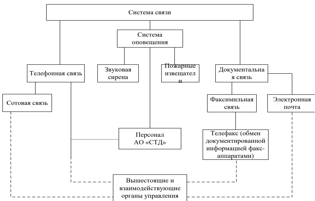
Рисунок 8 – Структурная схема связи ООО «СТД»
