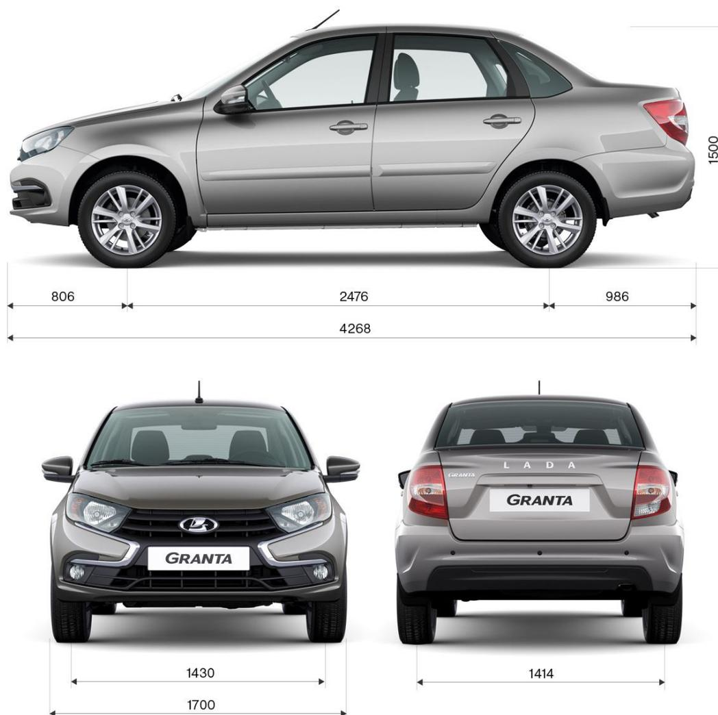
Рисунок 1 – Внешний вид и геометрия автомобиля Lada Granta
