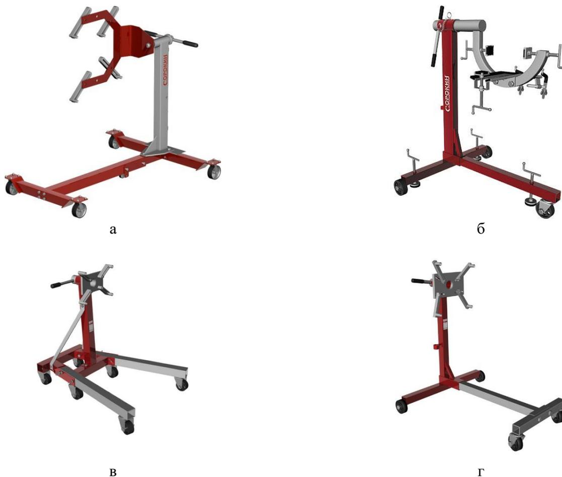
Рисунок 10 – Кантователи агрегатов: а) 8.55; б) 8.70; в) 8. 61; г) 8.64.
