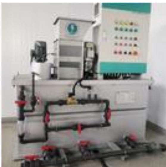
Рис. 4 – Станция приготовления и дозирования реагента
