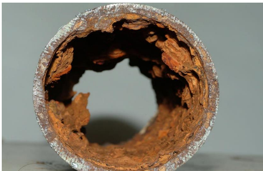
Рисунок 4 – Газовая коррозия стали
