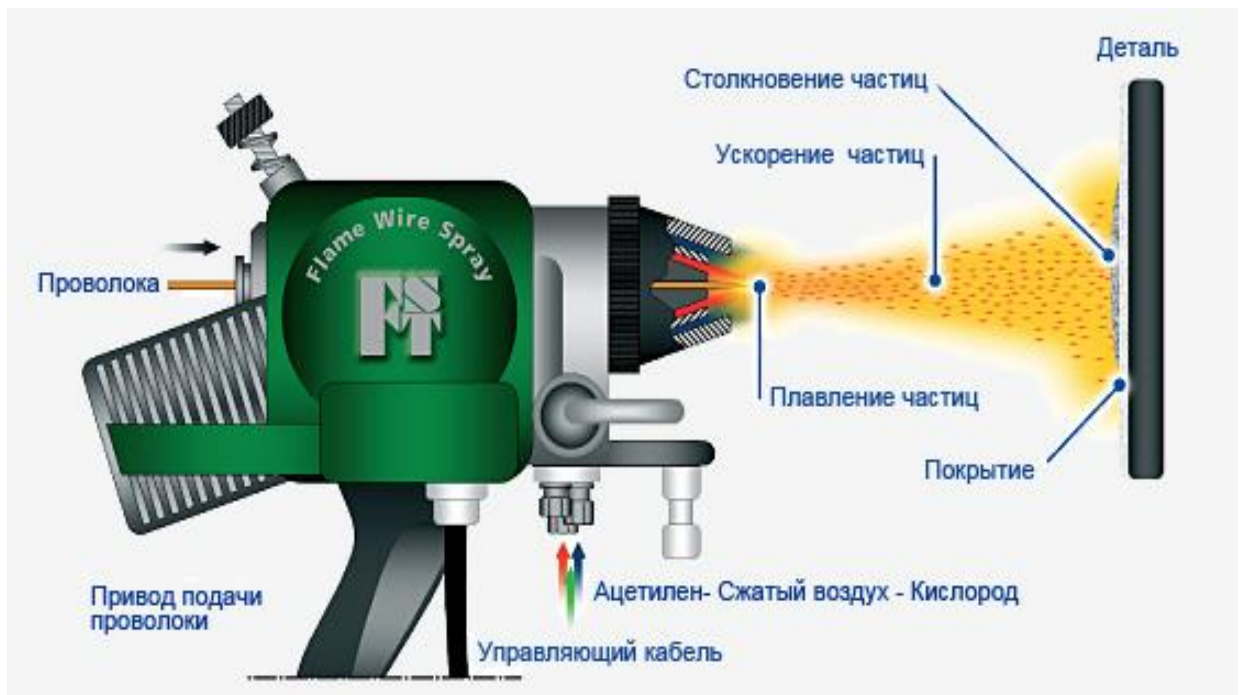
Рисунок 14 – Проволочное газопламенное напыление
