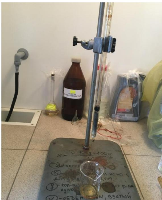
Рисунок 6 – Хроматографическая колонка для проведения анализа на содержание нефтепродуктов в сточной воде
