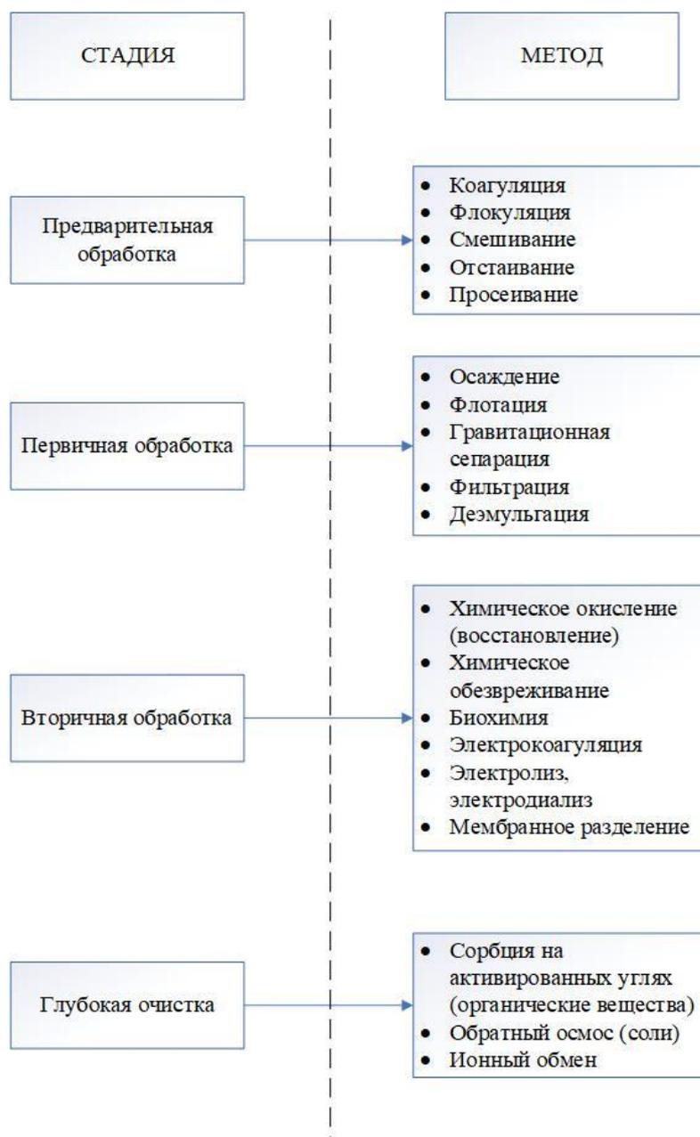
Рисунок 1 – Схема последовательного применения методов очистки питьевой воды
