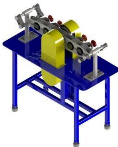
Рисунок 6 – Вибрационный истиратель для подготовки стекла фракции 50мкм
